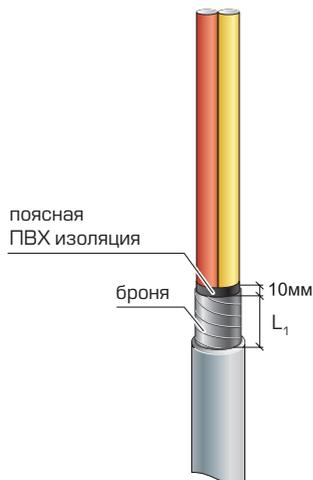
**2.1** Снять с кабеля оболочку и бронеленты согласно размерам, указанным на рисунке.
